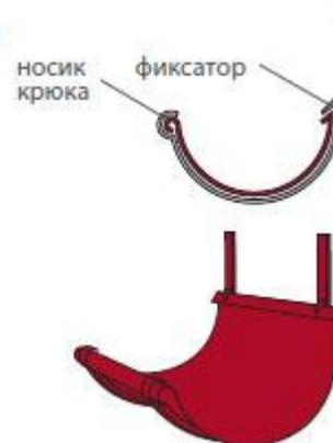
Продолжение края металлочерепицы или кровельного профнастила должно свисать над желобом на 50 мм.
