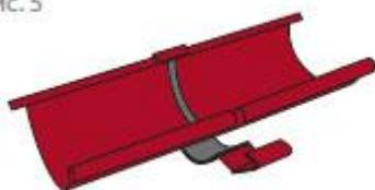
При соединении желобов водостока между собой и с углами желоба необходимо оставить расстояние между желобами в 3-4 мм. Для большей надежности, загерметизируйте стыки силиконовым герметиком. Для установки соединителя необходимо отогнуть замок на 60-90°, затем надеть соединитель завальцованной стороной на заднюю часть желоба, выровнять соединитель и защелкнуть замок на внешней части желобов (рис. 5). Зафиксируйте замок, вернув фиксатор в изначальное положение.
