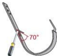
Установка длинных крюков производится в соответствии с предлагаемой инструкцией на стропила или на карнизную доску до укладки кровельного материала (рис. 1а, 1б). В случае если крюки устанавливаются после полного устройства кровли, необходимо для монтажа воспользоваться компактными или короткими крюками для крепления на лобовую доску.
